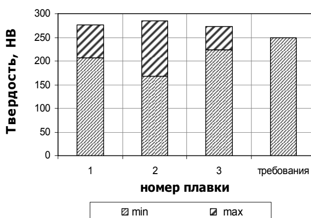
Рис. 1. Значения твердости горячекатаного проката из хромомолибденовой стали трех плавков после охлаждения на воздухе
